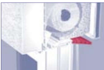
Intonacato all'interno con supporto e apertura di ispezione verso il basso
